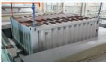
KTL-Grundierung im Tauchbecken
